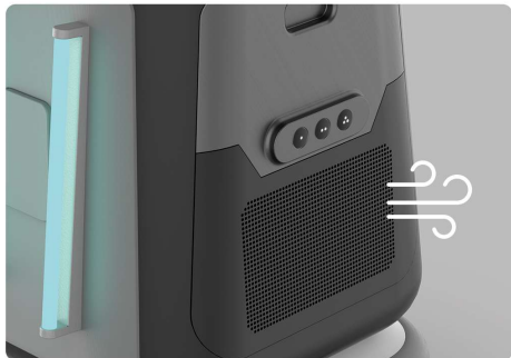
4 空气净化孔，净化鸡舍内空气。
